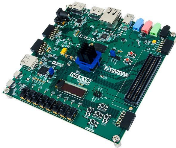
Figura 3-4. Placa Nexys Video de Digilent con FPGA de Artix 7.
