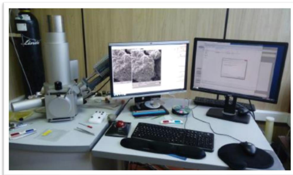
Figura 3.13 Equipo de microscopia electrónica de Barrido del departamento de metalurgia, USACH El mineral fue llevado a observación mediante SEM, entregando el resultado expuesto en la tabla 3.9 de la composición elemental del mineral.
