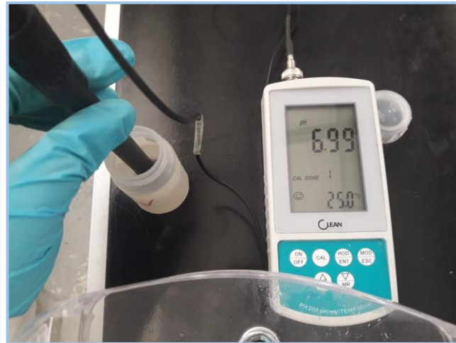
Imagen 21 : Solución buffer a pH=7 para calibrar phmetro.
