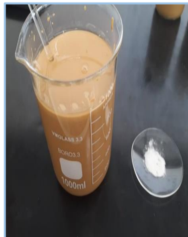
Imagen 25 : Revolviendo el reactivo añadido en el relave con varilla de vidrio.
