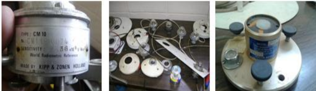
Figura 1.17: Fotos de distintos piranómetros del laboratorio.-
