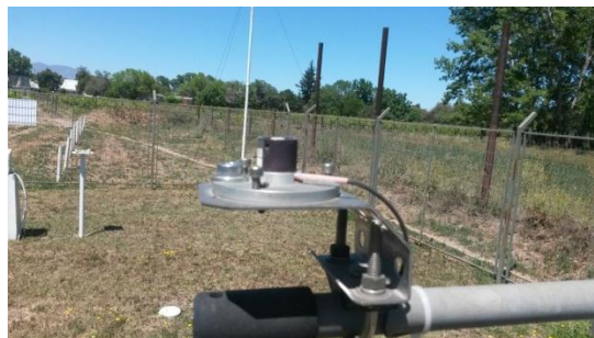
Foto 5: Sensor de Radiación Solar.-
