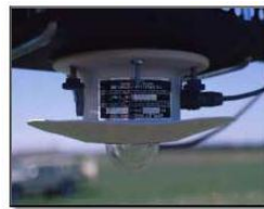
Figura 1.2: PIRANÓMETRO RADIACIÓN SOLAR REFLEJADA.-
