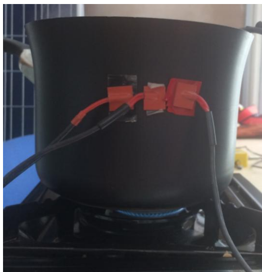
Figura 23: Prueba adhesión termocuplas con cinta doble contacto
