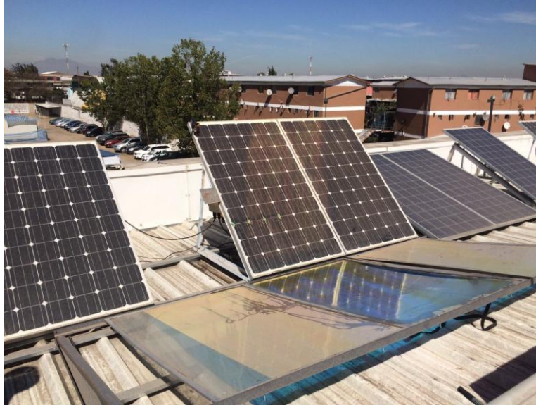
Figura 46: Reflejo sobre panel con 1/3 de reflector sin polvo
