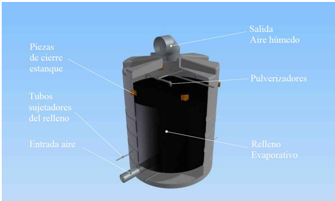
Figura 3-8. Diseño del humidificador del desalinizador.
