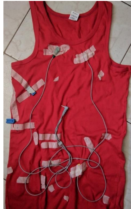
Fotografía 19 Primer esquema de electrodos sobre polera de algodón
