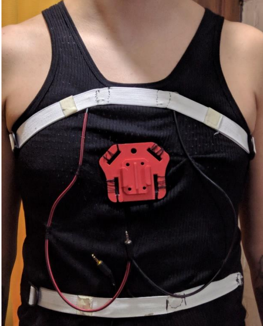
Fotografía 29 Polera con soporte para hub
