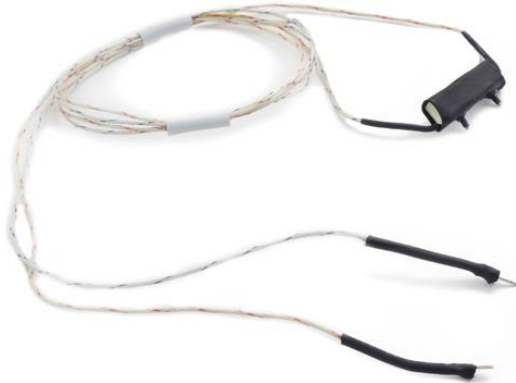
Fotografía 11 Sensor de flujo respiratorio Fuente: https://www.cooking-hacks.com/airflow-sensor-breathing-ehealth-medical
