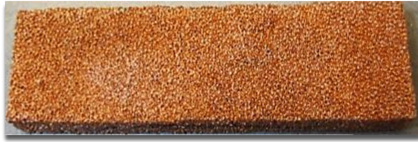
Figura 21. Ejemplo de espuma de Cobre de poro abierto [38].
