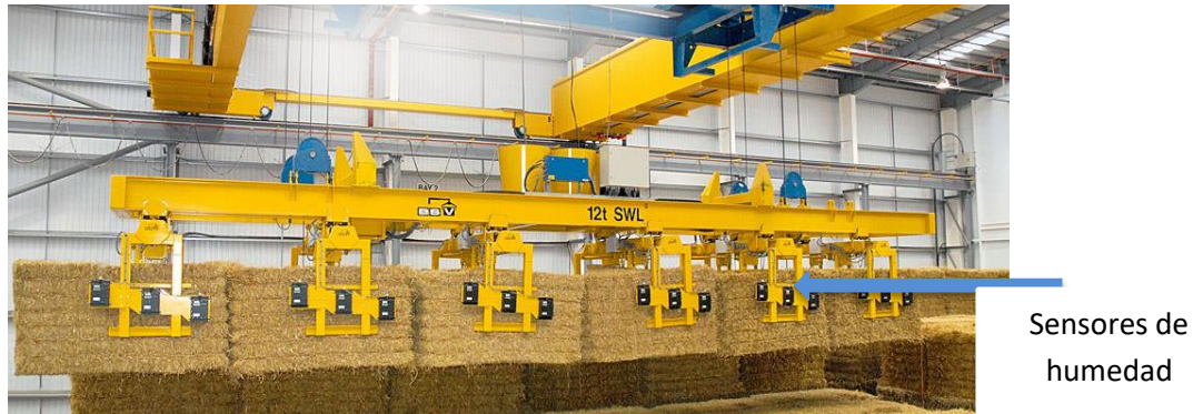
Figura 13-3: Descarga automática de fardos de paja de cereal
