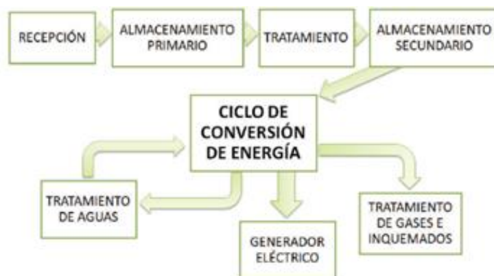
Figura 10-1: Diagrama de bloques de una central de biomasa.
