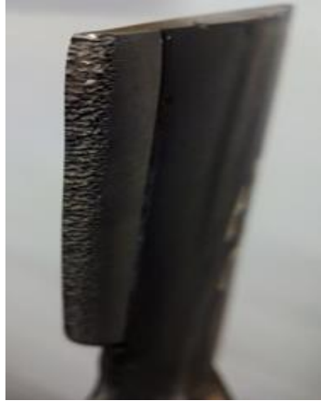
Figura 10-7: Daño en alabe producto de erosión por vapor húmedo en la última etapa de la turbina.
