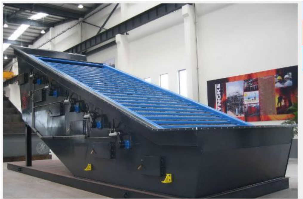
Figura 12-6: Vista de una parrilla reciprocante de una caldera biomasa
