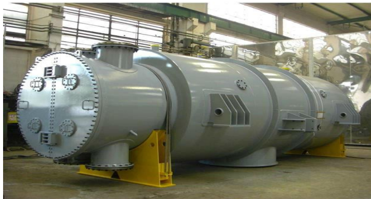
Figura 12-13: Vista de un condensador de vapor
