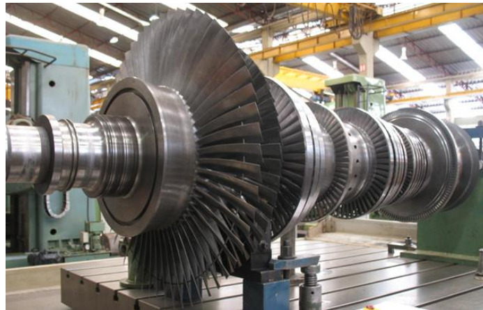
Figura 12-11: Vista de un rotor de condensación de una turbina
