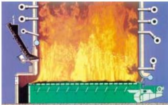
Figura 12-8: Vista de la base de una caldera de parrilla vibratoria
