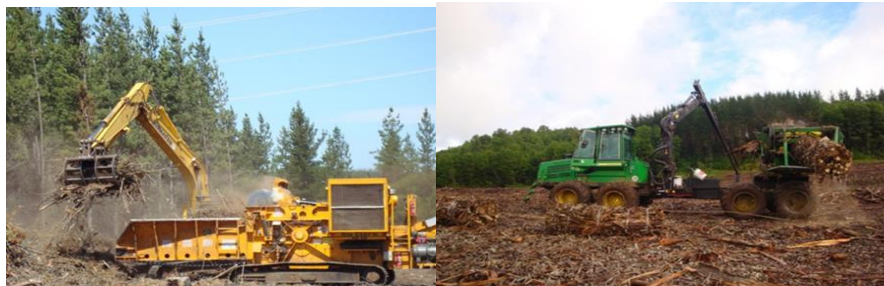
Figura 9-14: Desechos de bosque. Este combustible es el que se obtiene de la trituración los residuos que quedan en el bosque después de una cosecha.
