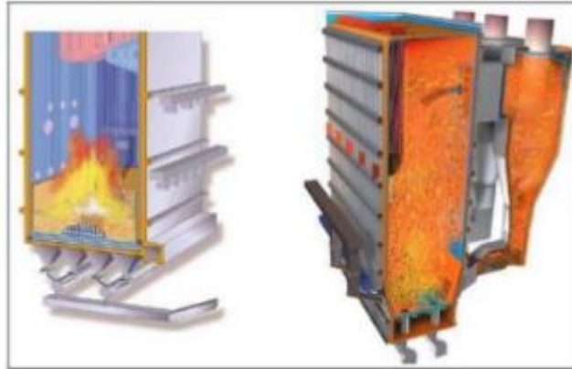
Figura 12-9: Vista de la base de una caldera de lecho fluidizado
