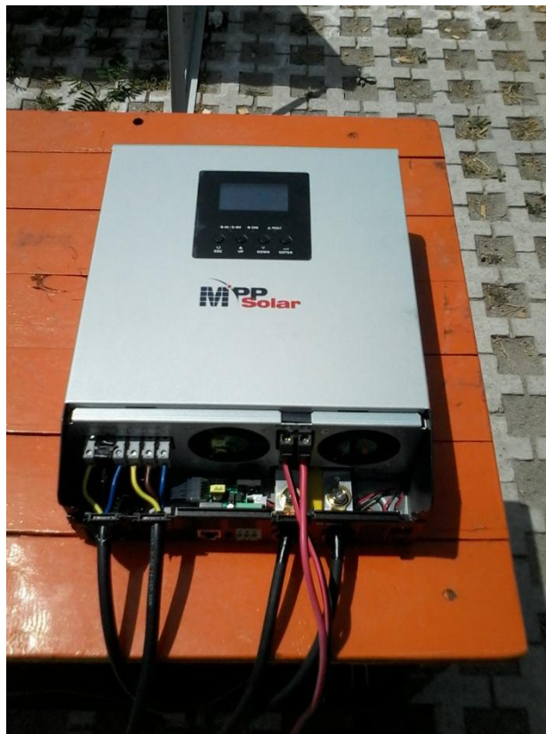
Figura 4.3: Conexiones hechas en el inversor.
