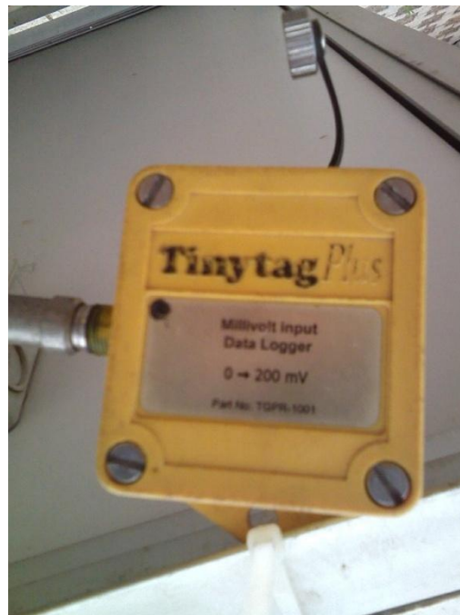
Figura 3.18: "Data logger" utilizado.
