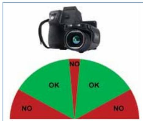
**Figura 3.12: Ángulo de visión recomendado (verde) para inspecciones termográficas.**
