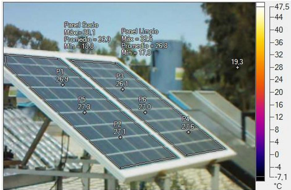
Figura 4.8: Temperatura promedio de ambos Paneles PV de Poli-Si en formato Visible Completo.
