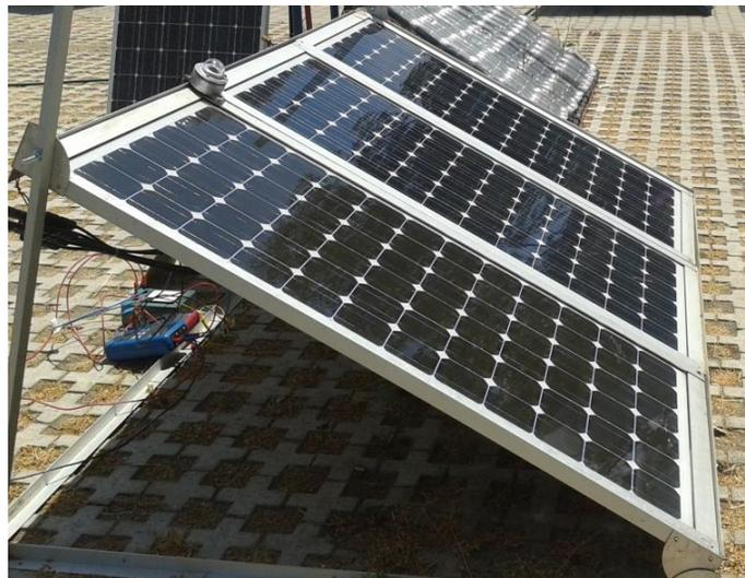
**Figura 4.6: Sistema de Módulos Fotovoltaicos de Mono-Si (PV2) después de la limpieza.**
