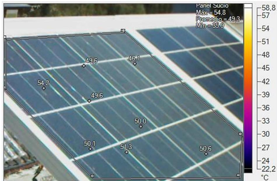
**Figura 4.12: Acercamiento a Panel PV de Poli-Si sucio en formato Visible, aproximadamente a las 14:28 hrs.**
