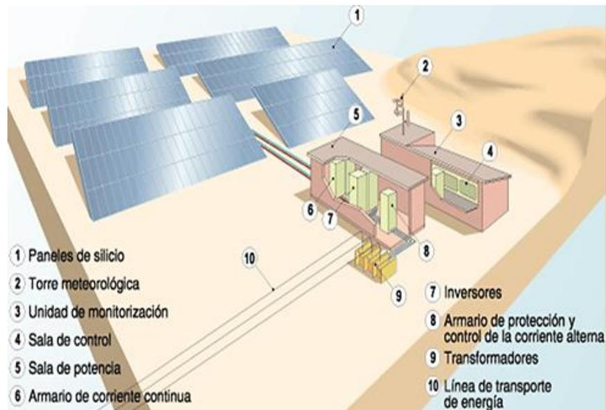
Figura 2.11: Esquema general de Planta Solar Fotovoltaica.
