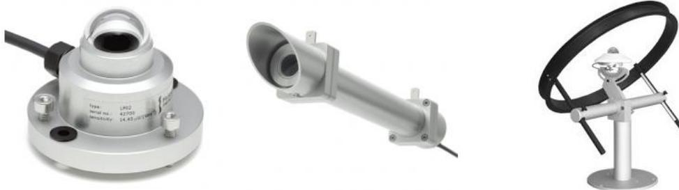
**Figura 2.3: De izquierda a derecha: Piranómetro, Pirheliómetro y Piranómetro con Anillo de Sombra.**
