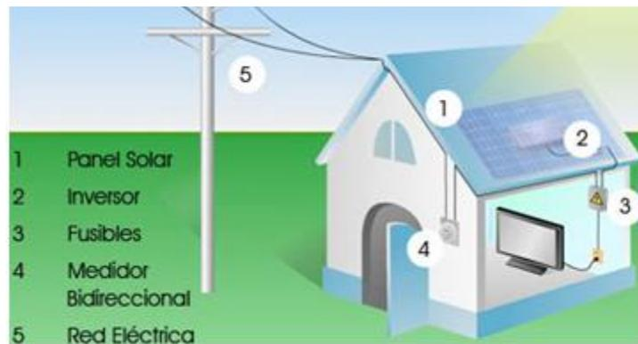
Figura 2.10: Sistema Fotovoltaico On-Grid a nivel doméstico.
