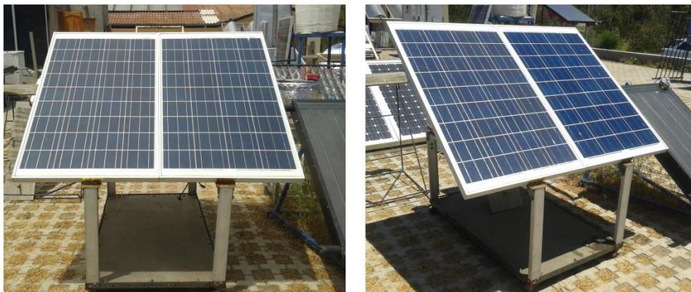
**Figura 4.4:** Sistema de Módulos Fotovoltaicos de Poli-Si (PV1). Izquierda: Ambos módulos sin limpiar, Derecha: Módulo izquierdo sucio y módulo derecho limpio.
