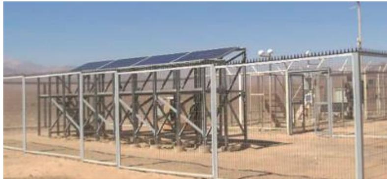
**Figura 2.23: Estación de Investigación de los efectos de la suciedad en el Desierto de Atacama, Mainstream Renewable Power. Fuente: Kipp & Zonen, <<http://www.kippzonen.es/>>.**
