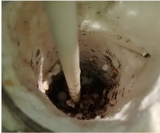
Figura 5.26: Aglomeración de ceniza en el reactor
