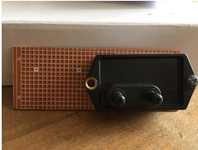
Fig. 1.8: Sensores de presión (Ambos modelos son iguales en forma).
