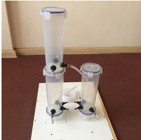
Fig. 1.3: Sistema Final de Estanques Acoplados.
