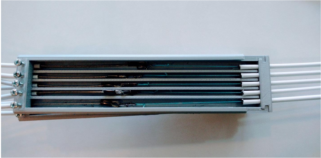
Figura 40: Vista interior sistema calibración. Se aprecian los cinco pares de sensores dedicados a cada dedo.
