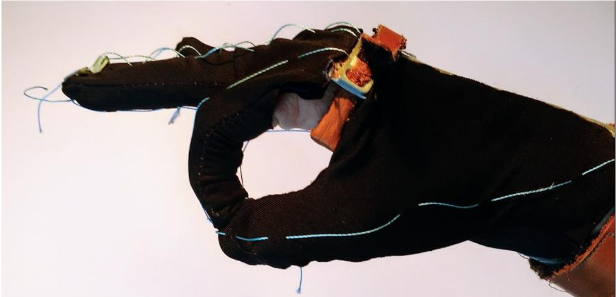
Figura 31: Vista lateral de la mano en pinza. Cable de flexión dedo índice en tensión. Se puede ver las rectas formadas por el tensor entre los puntos guías de la tela.
