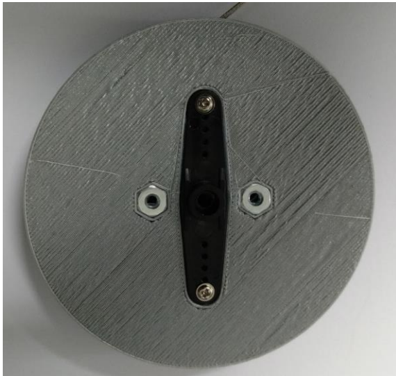
Figura 44: Vista inferior de polea. Brazo del servo encajado en la pieza. Las tuercas M3 también embutidas son para fijar la polea superior de ser necesario.
