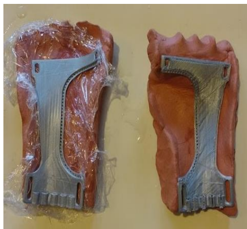
Figura 35: Piezas de PLA maleables en moldes de pasta para modelaje.
