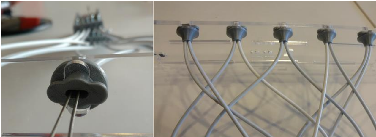
Figura 48: En la izquierda se ve la vista desde el interior del dispositivo, se distingue el sacado de la pieza acrílica y también la rotación de 90° de la pieza para ser fijada. En la derecha se ven las cinco piezas, una para cada dedo, donde se conectan las fun fundas de flexión y extensión de cada dedo.
