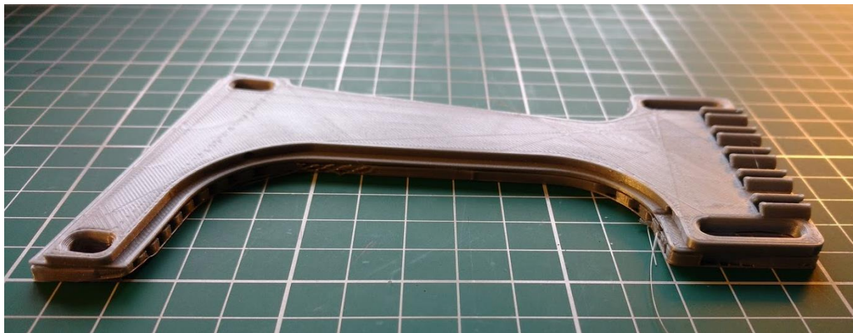
Figura 34: Pieza Guía de tendones luego de ser fabricada en FDM y antes de ser moldeada anatómicamente.
