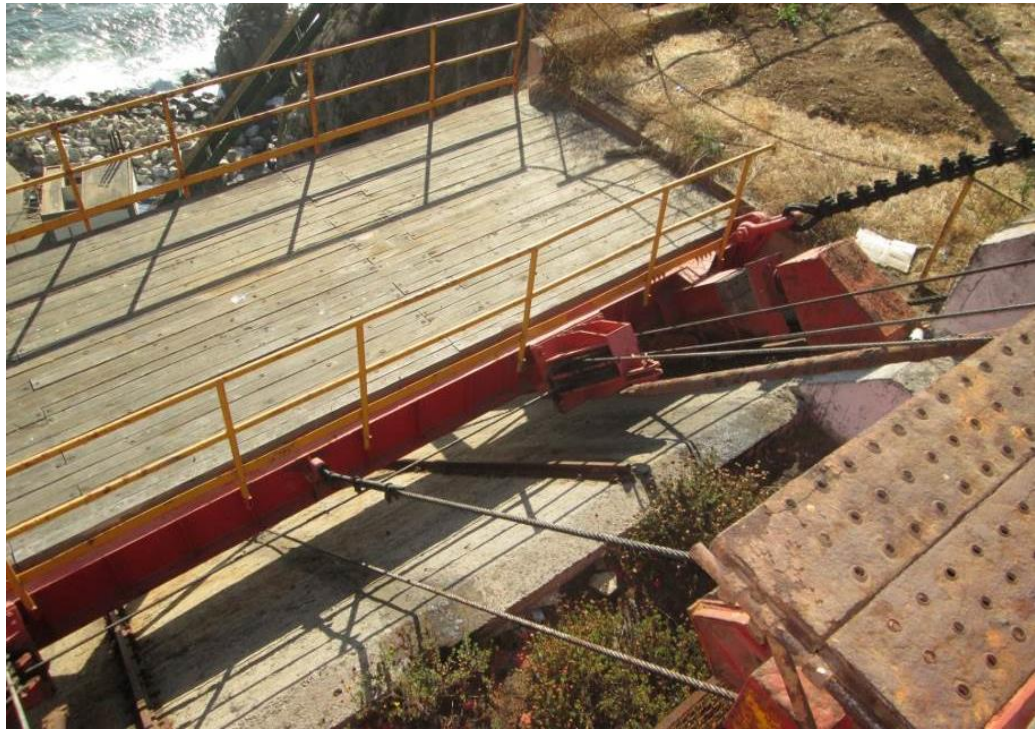
Figuraa 20: Poleas de desvío en carro y fijación de cable de reenvió en carro.
