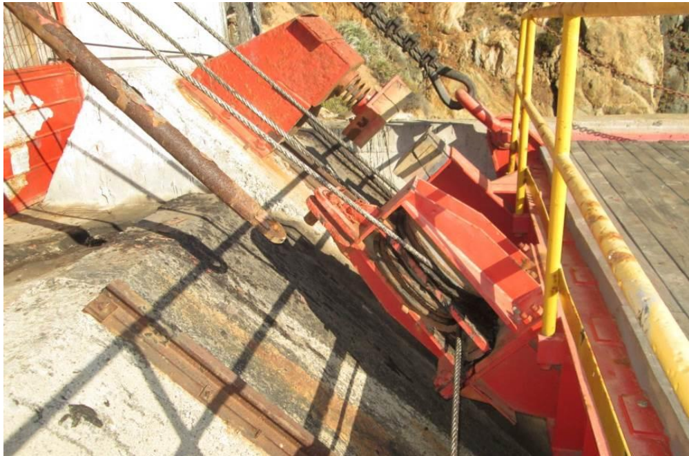
Figura 22: Polea Horizontal de desvío.
