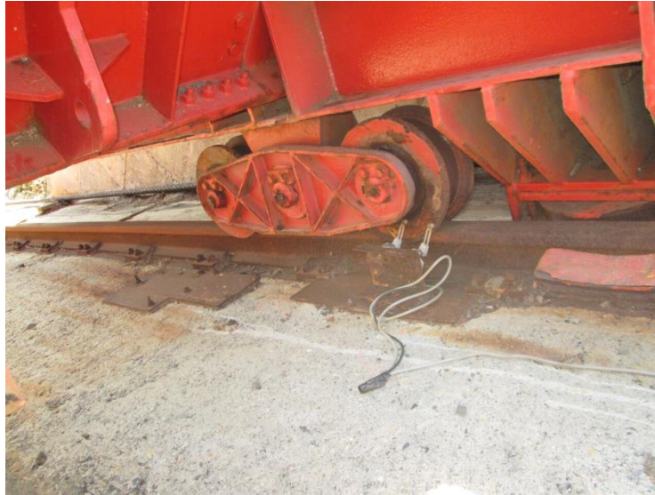
Figura 55: Rodado vertical y horizontal del carro.
