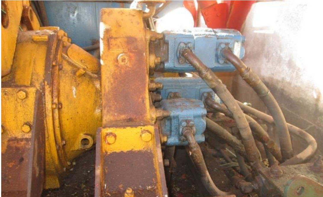
Figura 14: Bombas hidráulicas accionadas por el Motor Diesel.
