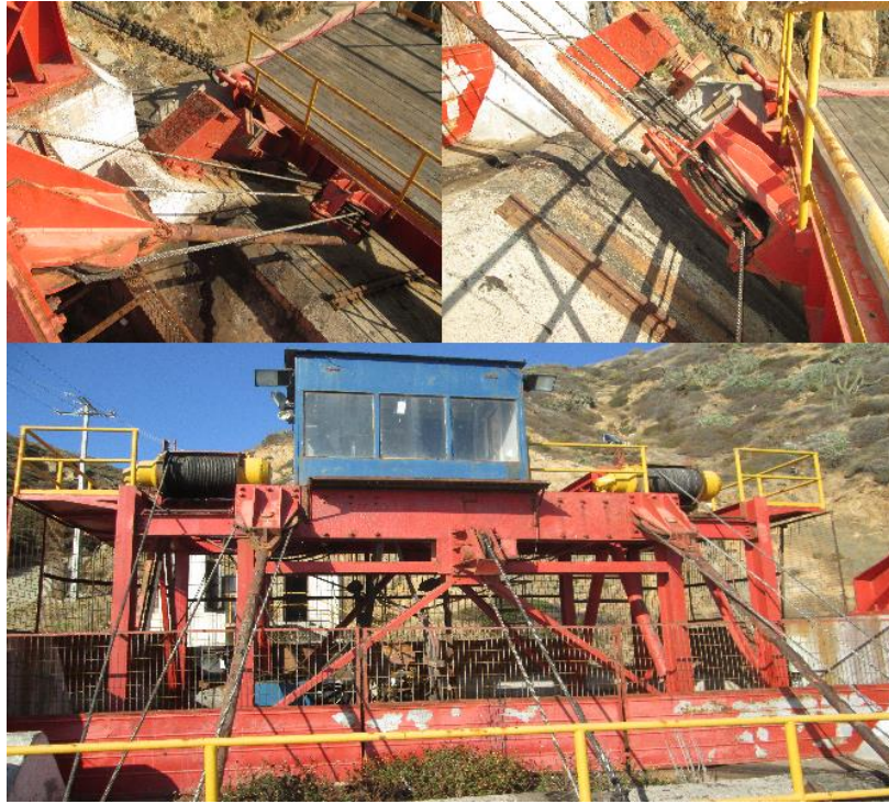
Figura 58: Estado actual de suspensión, arrastre y reenvío.
