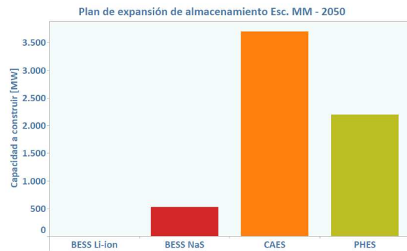
Fig. 4.19: Plan de expansión de almacenamiento por tecnología en Escenario MM año 2050.
