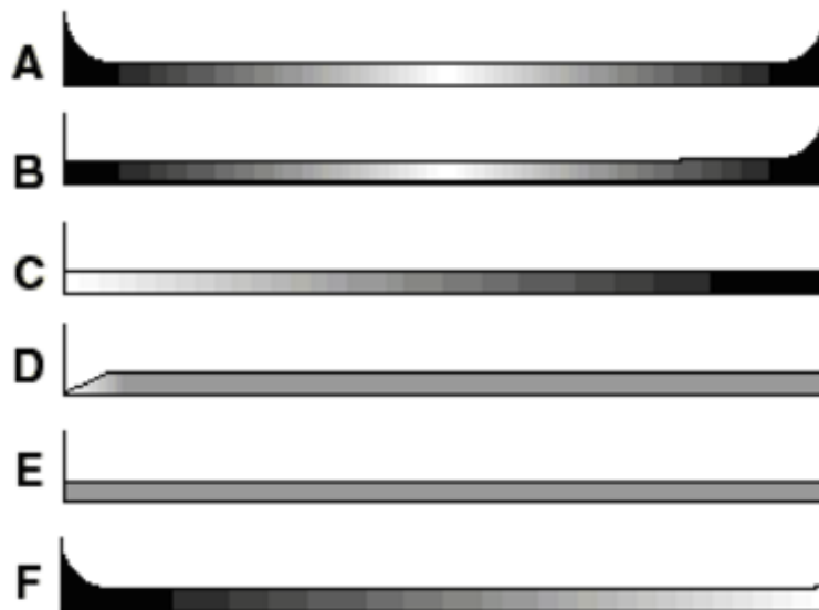
Figura 10 Curvas de probabilidad de fallos en distintos tipos de componentes [15].
