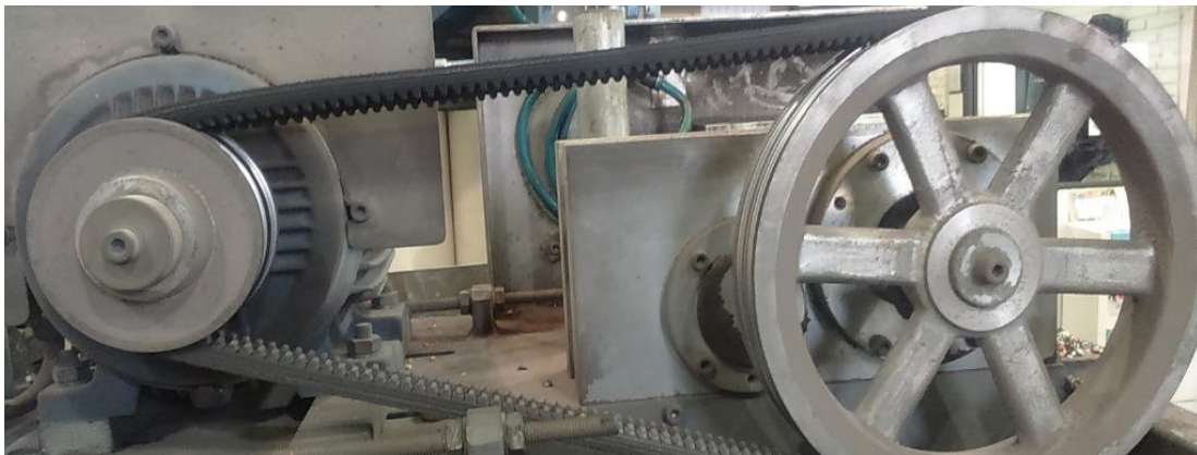
Figura 65 Tipo de transmisión en pelletizadores B y D
