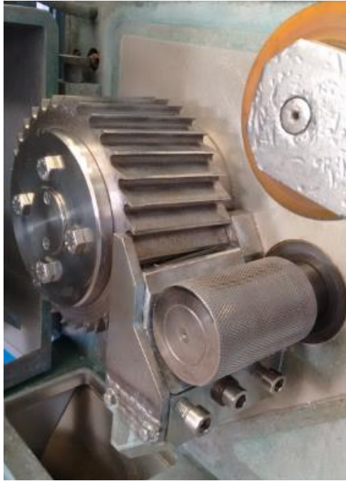
Figura 63 Cuchillo móvil y fijo pelletizador A y C.
