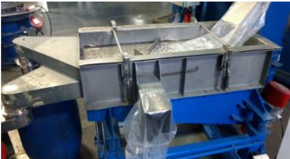
Figura 66 Tamizador de la planta Masterbatch.
