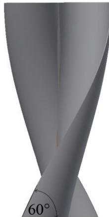
Figura 5.3 Ángulo helicoidal en un rotor de dos alabes
