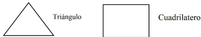
Figura 4.8 Elementos usados para la discretización en 2D
