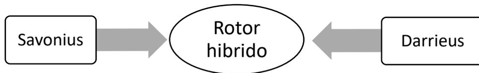
Figura 5.1 Combinación de los dos tipos de rotores más usados en turbinas de eje vertical
