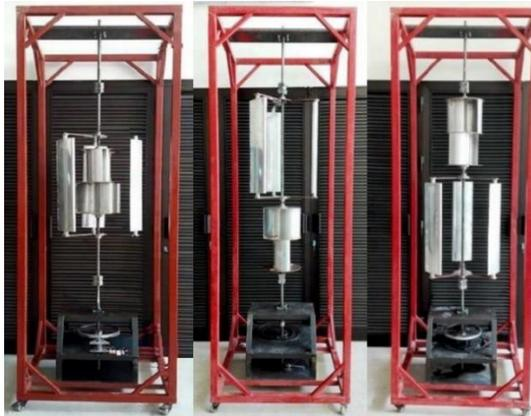
Figura 3.25 Distintas combinaciones de rotores presentados en el EESD 2016. A la izquierda la configuración A, en el centro la configuración B y a la derecha la configuración C.
