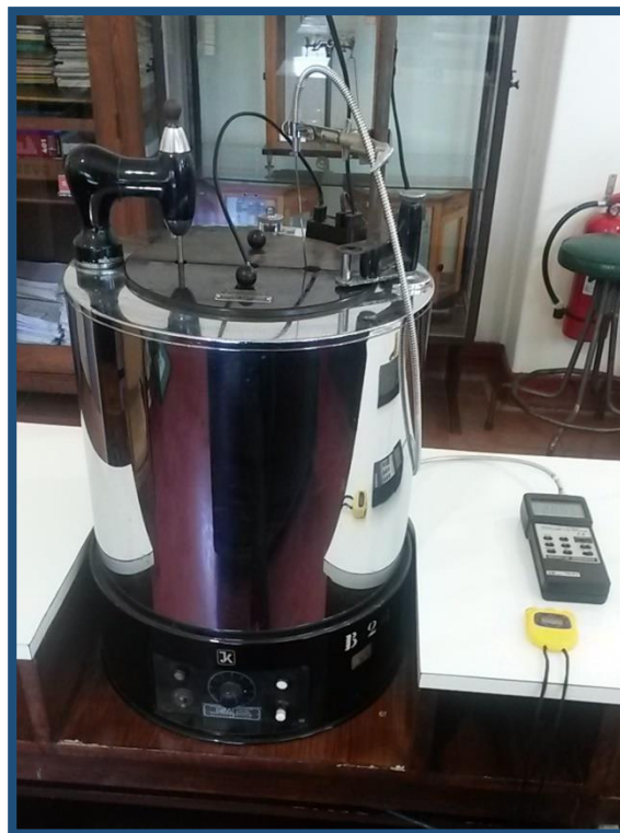
Ilustración 36: Calorímetro, utilizado en ensayo de poder calorífico inferior.
