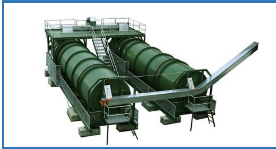
Ilustración 26: Vista de un sistema de Tambor rotativo de compostaje estándar. [14]
