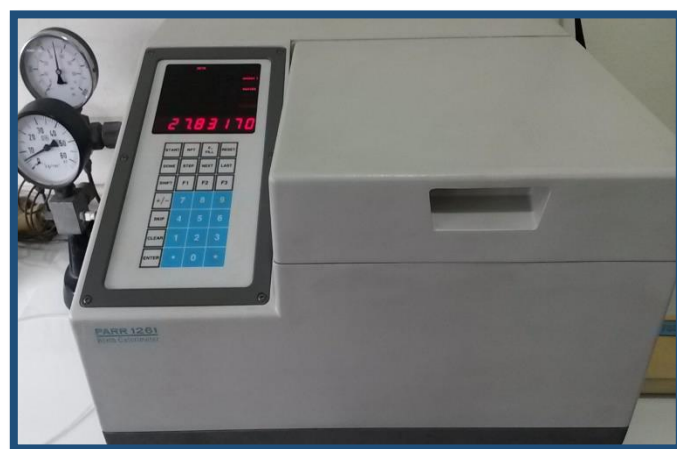
Ilustración 6: Calorímetro isoperibólico, utilizado en ensayo de poder calorífico superior.
