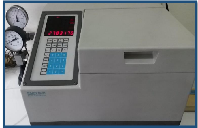
Ilustración 37: Calorímetro isoperibólico, utilizado en ensayo de poder calorífico superior.
