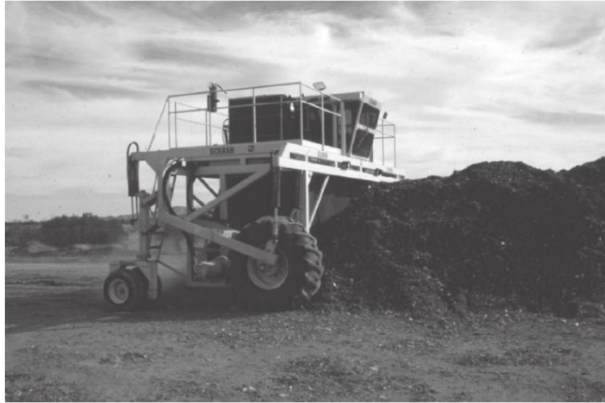
Ilustración 22: Máquina volteadora de compost, Sistema de pila móvil. [13]
