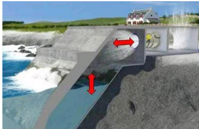
Figura 1.8 Rompeolas donde está instaladas las turbinas de generación [9]
