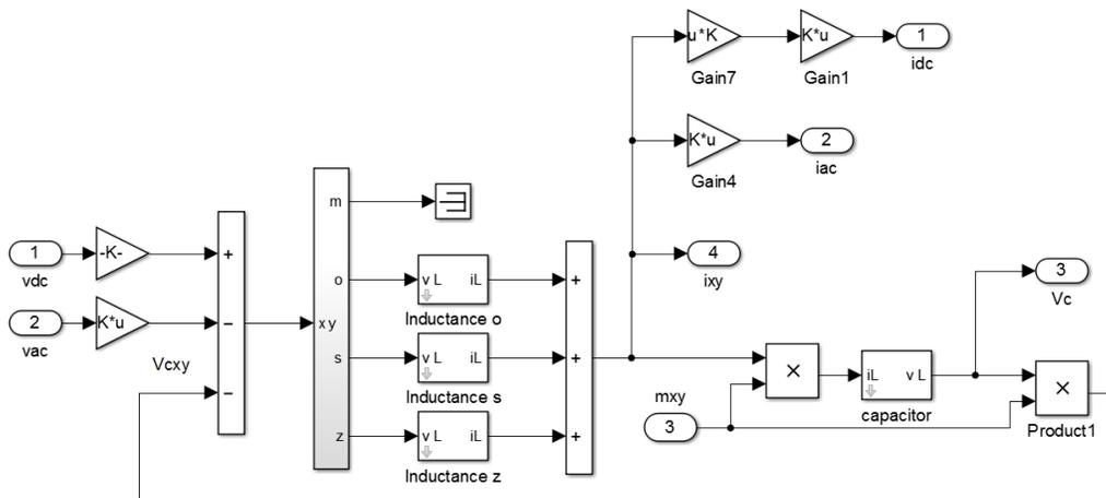
**Fig.2.6. Modelo Convertidor Modular Multinivel – Simulink.**
