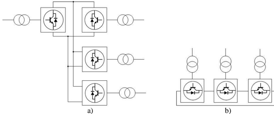
**Fig. 1.6. Configuración multiterminal. a) paralelo. b) serie.**
