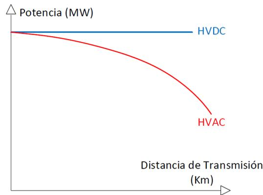
Fig. 1. Gráfico relación potencia versus distancia de transmisión.
