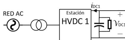
**Fig.3.8. Modelo Sistema HVDC – Convenciones de Corriente y Voltaje.**
