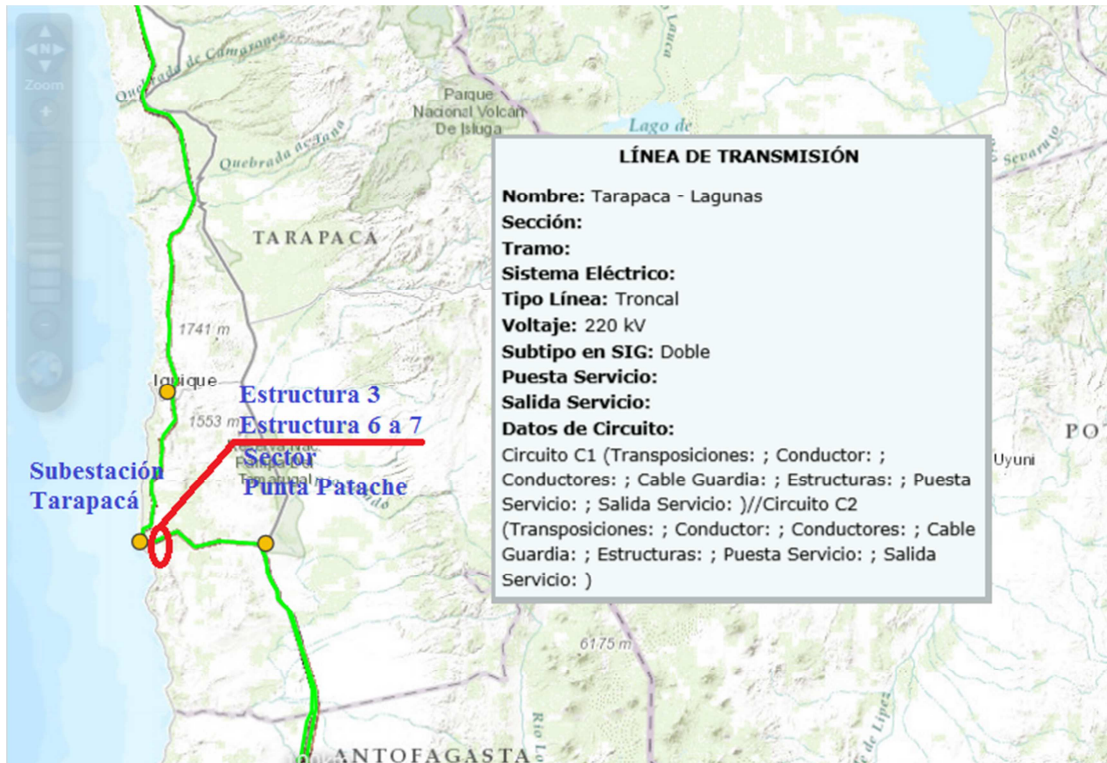
Figura 3.15 Ubicación geográfica de fallas en líneas Tarapacá-Lagunas 1 y 2 220 kV
