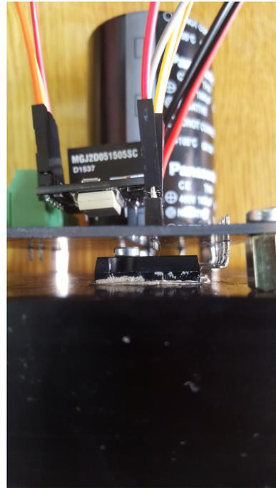
(b) Montaje IGBT al disipador.
