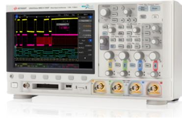
(b) Osciloscopio DSO-X 3024A.
